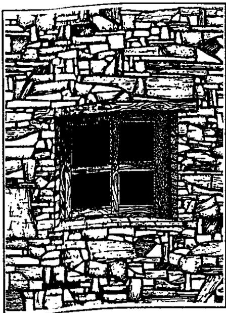
Foro di forma prevalentemente quadrata con contorno in muratura ed architrave costituita da un travetto di legno in vista.
